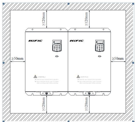
图2-6 多台变频器左右并排安装示意图
